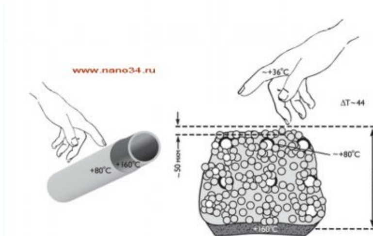
Рис. 3. Иллюстрация теплового парадокса покрытия КОРУНД.
